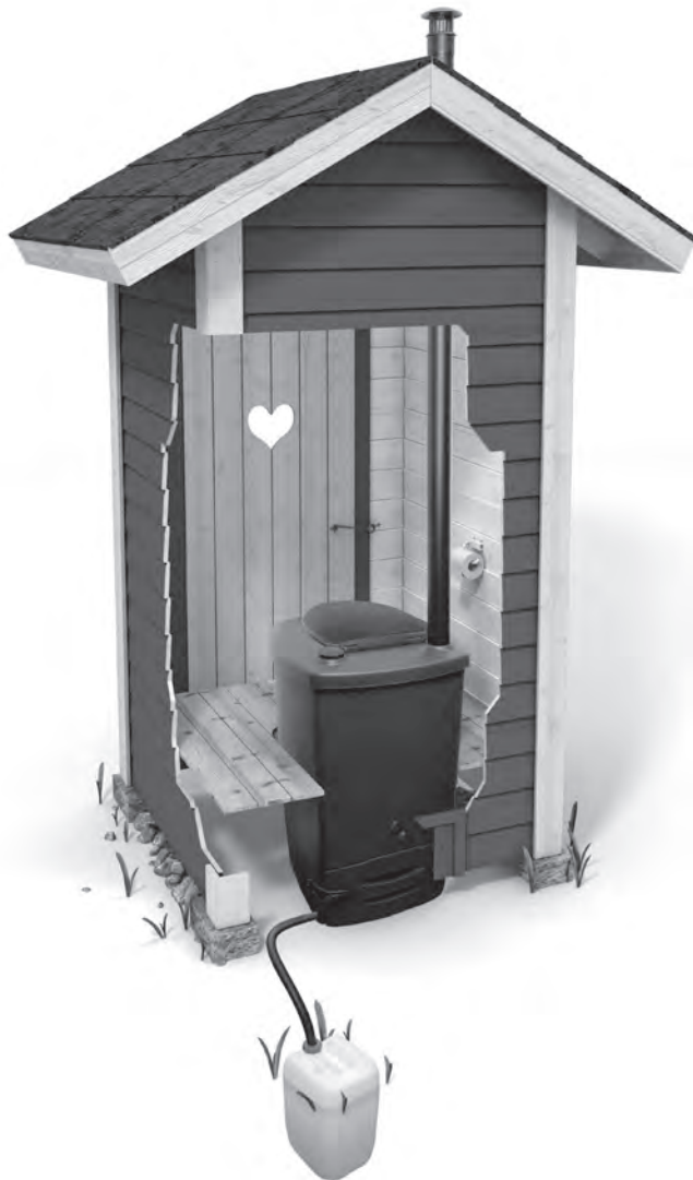
Attēls ar piemēru, kā uzstādīt sauso tualeti un novietot šķidruma novadīšanas tvertni.
