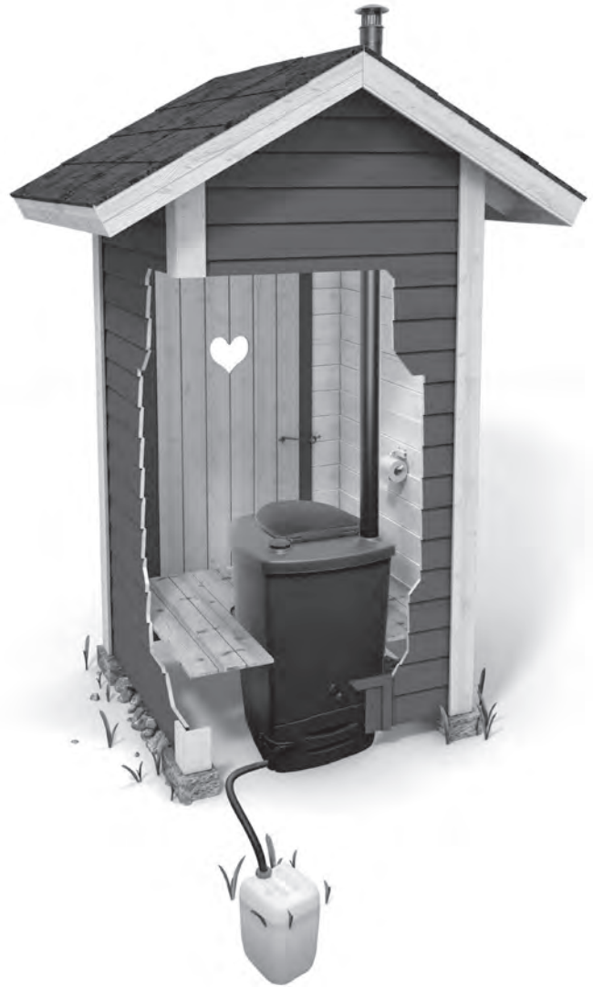
Imagen que muestra un ejemplo de instalación del inodoro y la colocación del recipiente para líquido.
