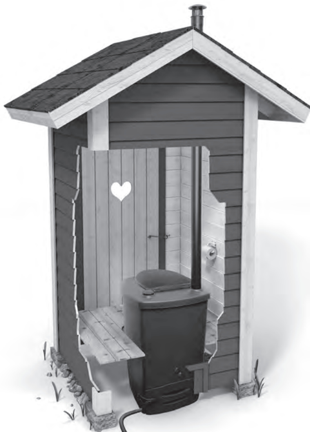
Изображение примера установки туалета и размещения канистры для сбора фильтрата
