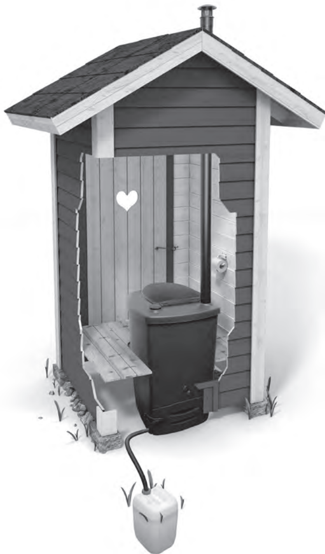
Ilustracja przedstawiająca przykład zainstalowania toalety i umieszczenia pojemnika cieczy.
