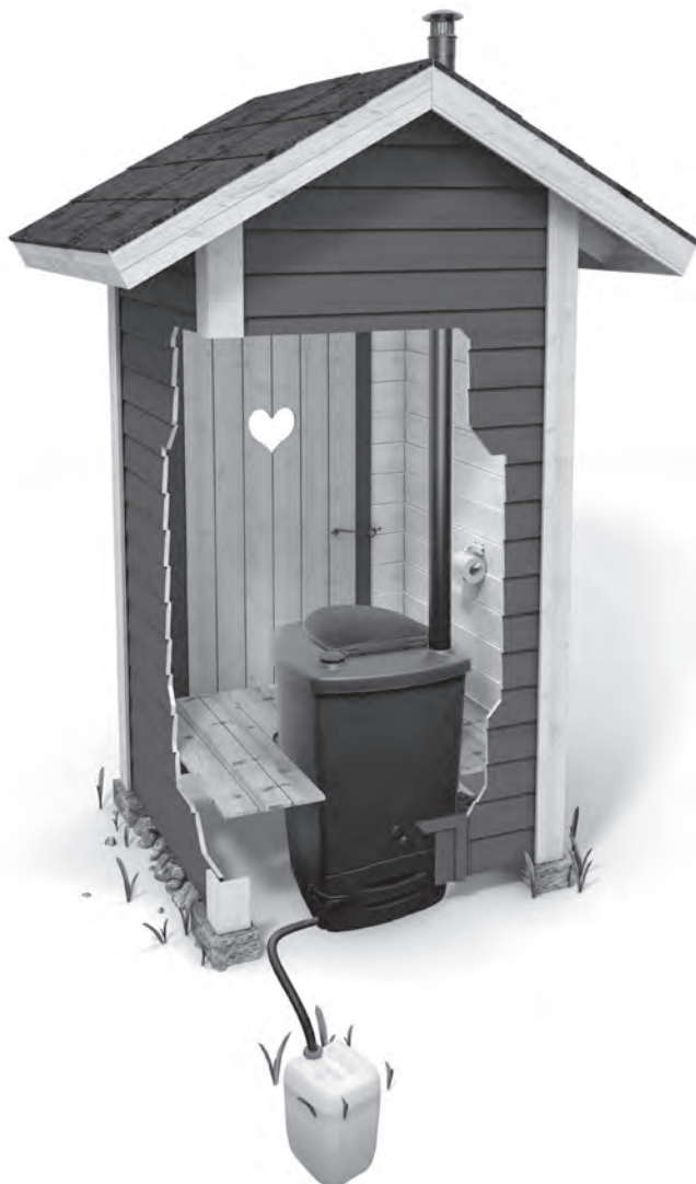
Exempelbild på toalettinstallationen och placeringen av kanistern.
