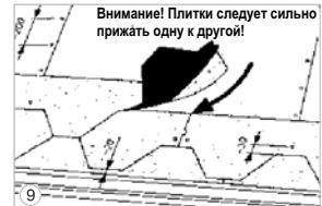
Следующий ряд плиток укладывается таким образом, чтобы широкие части плиток оказались над вырезами предыдущего ряда, закрывая также гвозди. Плитки сильно прижимаются одна к другой.
